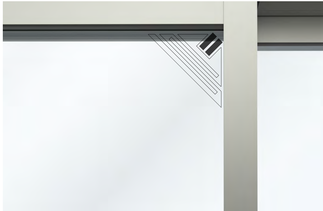
Die Alarmspinne meldet den Glasbruch an ein Meldesystem – der Alarm wird ausgelöst
